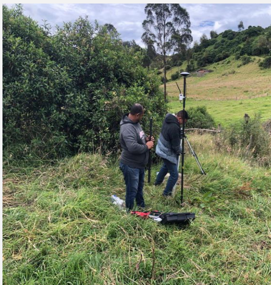
Fotografía 5. Calado para el cambio de estación
