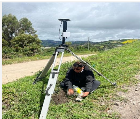
Fotografía 2. Receptor GNSS en Punto B
